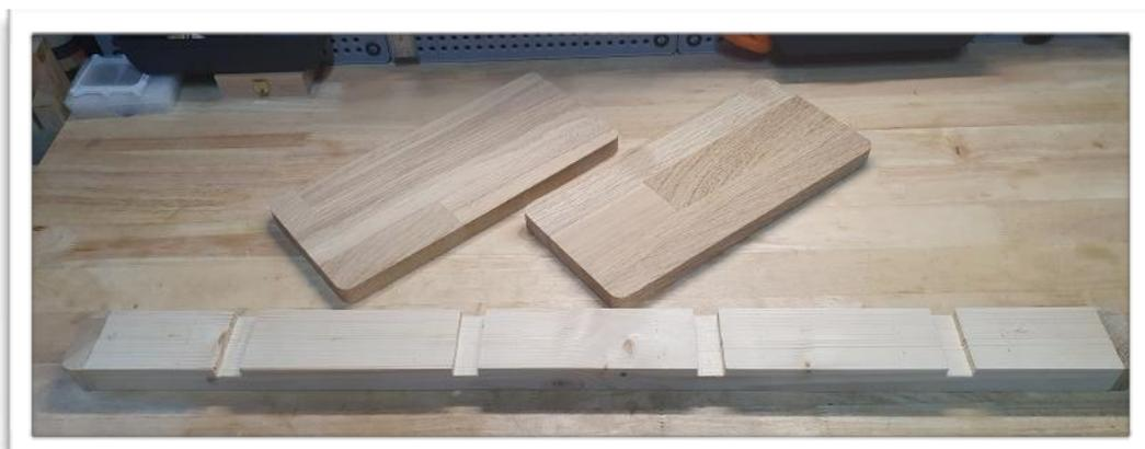
*A ce stade, on emboîte les tablettes pour voir si les défonces sont correctes. Si ce n'est pas le cas, on les rectifie soigneusement.*
