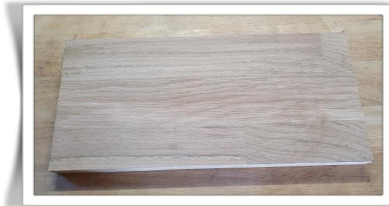
5) Au touret à poncer avec un disque de grain 150 (ou à défaut, à la ponceuse), je viens arrondir les angles afin d'avoir une meilleure finition. Il conviendra de tracer préalablement les arrondis pour plus de précision.
