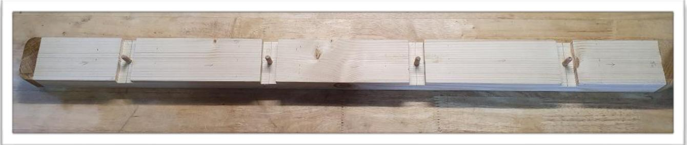
8) Pour que l'encastrement soit bon, je viens découper à la scie sauteuse des "U" dans les tablettes (largeur 5 cm, comme le tasseau, et sur une profondeur d'1,5 cm pour avoir un peu de marge lors de l'emboîtement). Chaque cavité est creusée à 2 cm du bord de la tablette. Je vous recommande d'utiliser une équerre pour tracer proprement.
